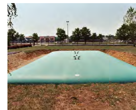
Waterbuffering door middel van een grote waterzak
